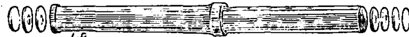
Fig. 567. — Tube pour canon de 90m/m, ébauché, foré, trempé et recuit (rondelles détachées).
