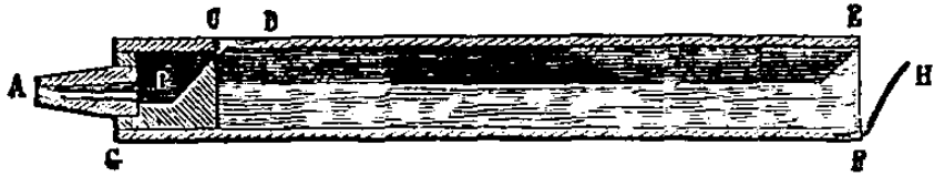
Fig. 27. — Tuyau à bouche.
