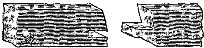
Fig. 194. — Assemblage à chaperon.
