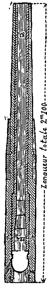
Fig. 496.— Canon léger de campagne, russe, modèle 1877, construit à l'usine d'Oboukhoff.
