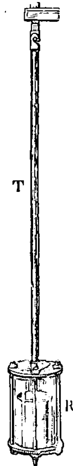
Fig. 256. — Principe du balancier compensateur à mercure.
