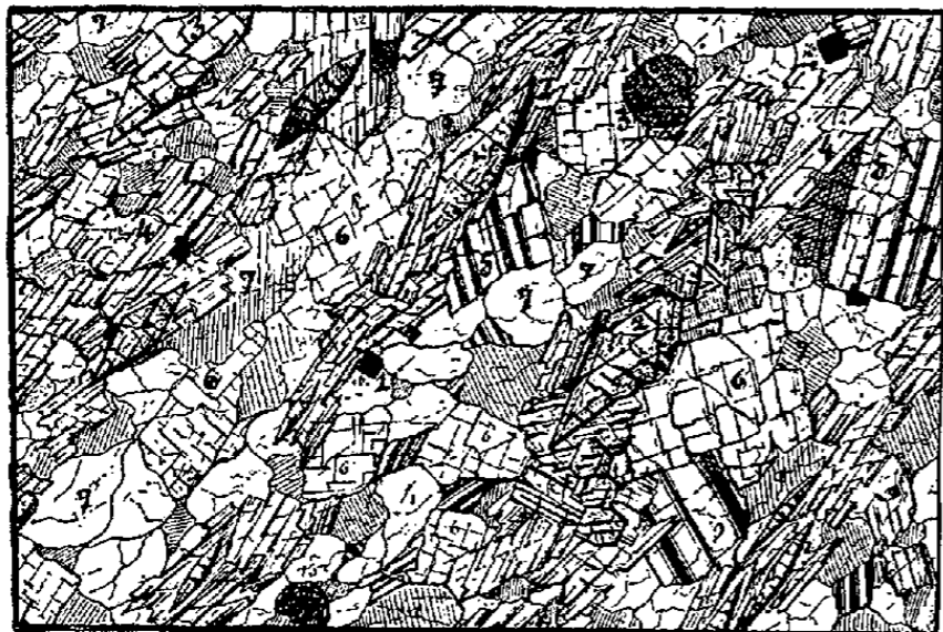
Fig. 3. — Gneiss amphibolite. (Lumière polarisée, nicols croisés; grossissement 40 diamètres.) — 1, magnétite; 2, sphène; 3, mica noir; 4, oligoclase; 5, orthose; 6, quartz; 7, quartz granulitique.
