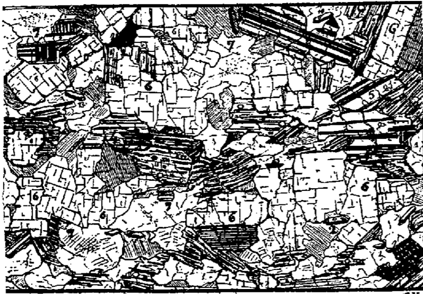
Fig. 2. — Gneiss granitoïde. (Lumière polarisée, nicols croisés, grossissement 40 diamètres.) — 1, apatite; 2, zircon; 3, mica noir; 4, oligoclase; 5, microcline; 6, orthose.
