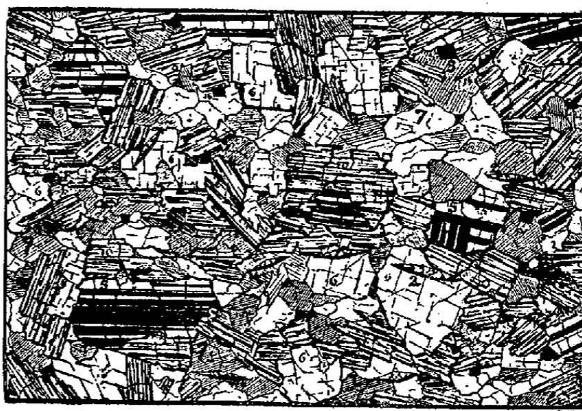
Fig. 1. — Gneiss gris. (Lumière polarisée, nicols croisés, grossissement 40 diamètres.) — 1, magnétite; 2, sphène; 3, zircon; 4, mica noir; 5, oligoclase; 6, orthose; 7, quartz.
