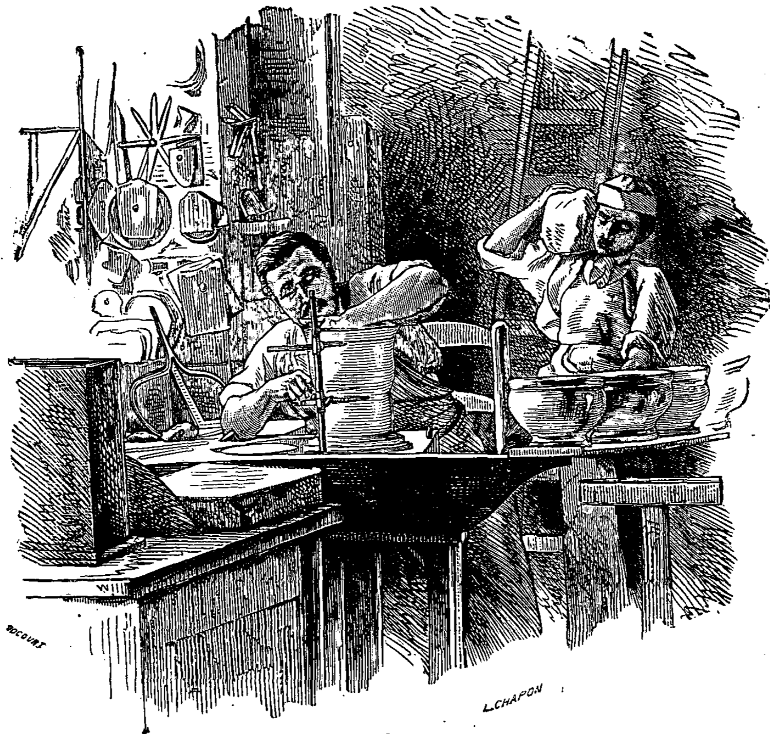
Fig. 8. — Ouvrier ébauchant une pièce sur le tour.
