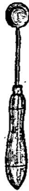
Fig. 137. Les boules de bois ou de fer (fig. 137) qui servent à bouler , c'est-à-dire à rendre convexes ou concaves les pétales des fleurs qu'il s'agit d'imiter. Le nombre des boules, chacune d'un diamètre différent (2 à 35 millimètres) varie de 10 à 12, la plus petite se nomme boule d'épingle .
