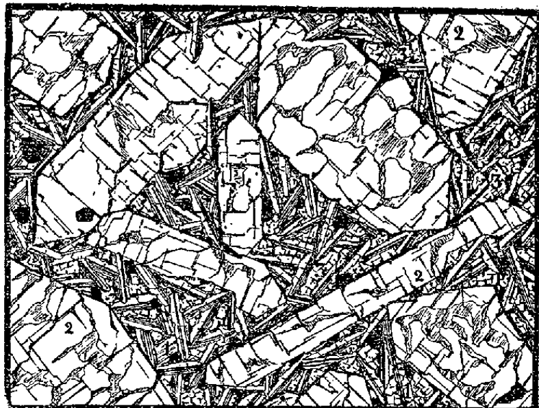
Fig. 5. — Basalte artificiel (d'après MM. Fouque et Michel Lévy. Synthèse des minéraux et des roches, 1882). — 1, Microlithes de labrador; 2, Microlithes granuleux d'augite; 3, Périidot; 4, Magnétite.
