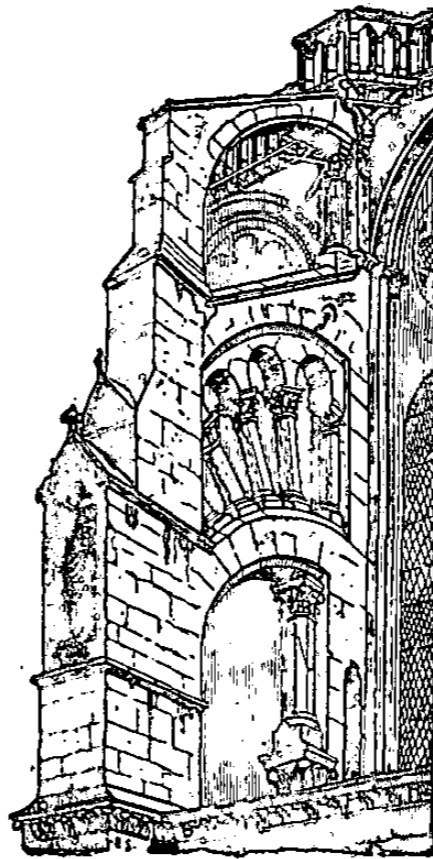
Fig. 495. — Contrefort à Chartres.
