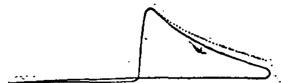
Fig. 320. — Cycle réel, mot. Lenoir.
