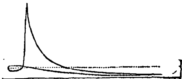
Fig. 324. — Cycle réel, moteur Langen et Otto.
