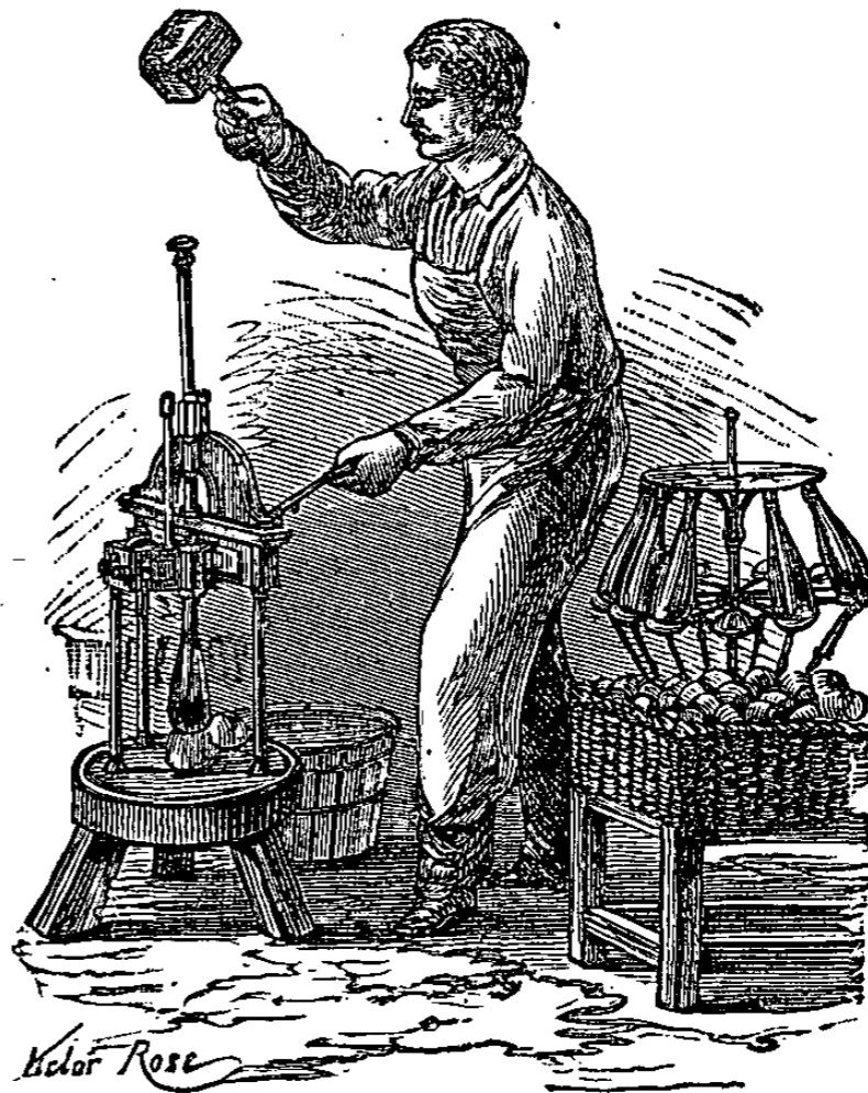
Fig. 814. — Ouvrier boucheur terminant le bouchage mécanique par un coup de maillet.
