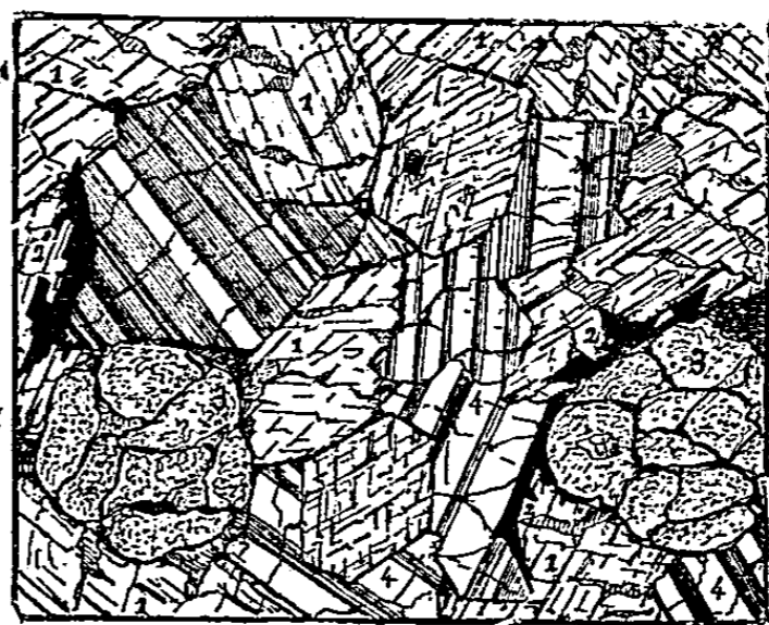
Amphibolite de Ranfaing près Remiremont (Vosges), vue au microscope sous un grossissement de 40 diam. Nicol à 45^\circ . — 1, hornblende; 2, fer titané; 3, grenat; 4, oligoclase.
