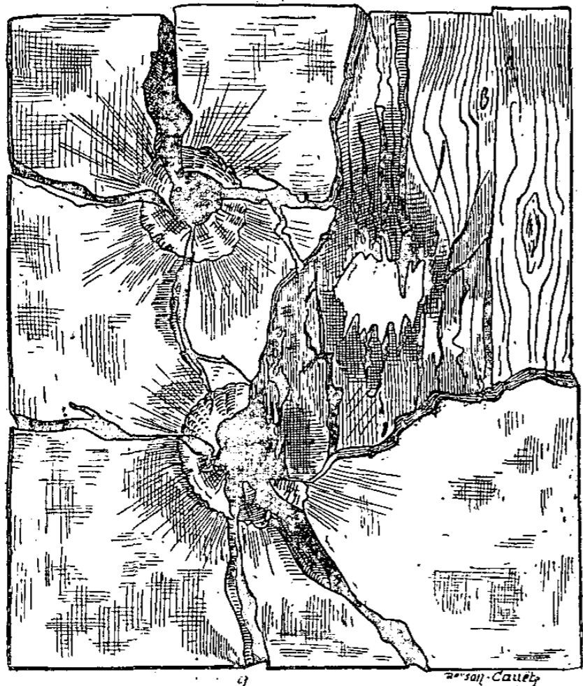
Fig. 225 et 226. — Essais comparatifs sur des plaques de blindage en acier et en métal Compound pratiqués au polygone d'Ochta, le 2 novembre 1882 et le 8 mars 1883. La vue de gauche représente la plaque en acier du Creusot après le troisième coup et celle de droite la plaque en métal Compound après le quatrième coup.
